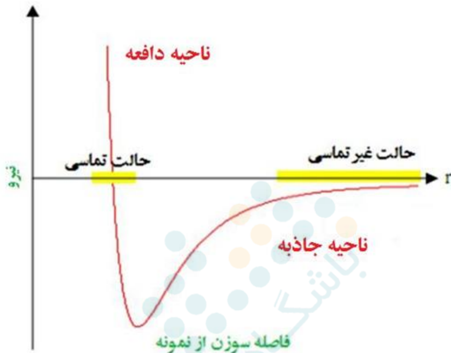
شکل (۳) نمودار انرژی پتانسیل پروب و نمونه [۱۶]
