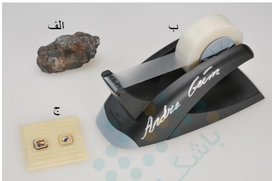
شکل ۷- الف) یک کلوخه از گرافیت، ب) چسب و ج) یک ترانزیستور گرافن [۹].
