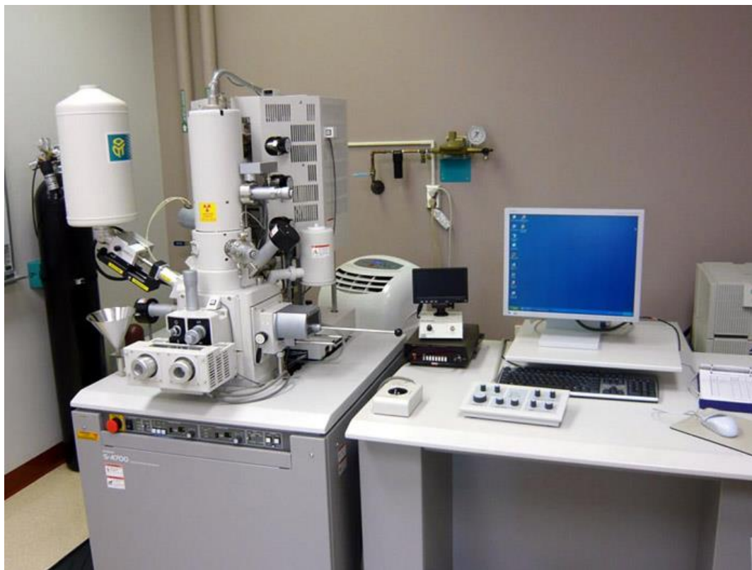
شکل ۲ - تصویری از یک دستگاه SEM امروزی [۶]
