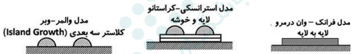
شکل ۲: سه مدل جوانه‌زنی در رسوب‌دهی از فاز گاز
