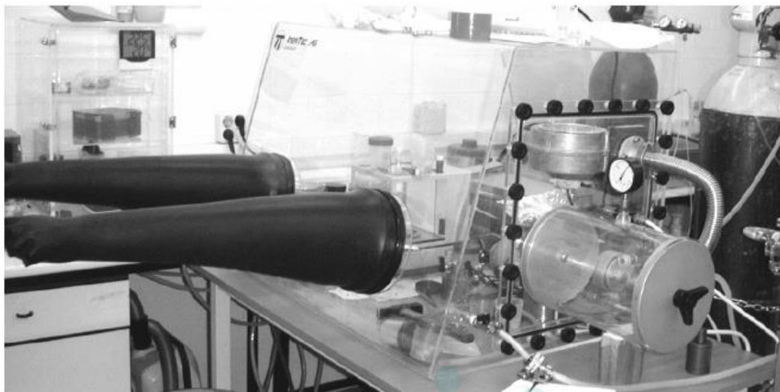
شکل ۲- تصویری از یک نمونه محفظه مجهز به دستکش به منظور کاهش آلودگی ناشی از هوای اطراف.
