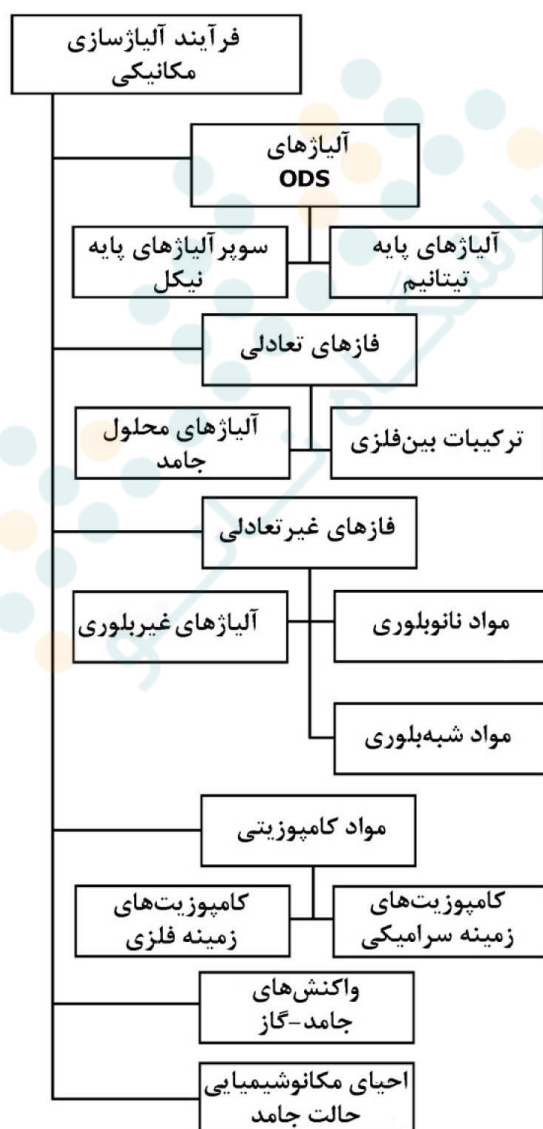
شکل ۱- شماتیکی از گستردگی مواد پیشرفته تهیه شده به روش آلیاژسازی مکانیکی.
