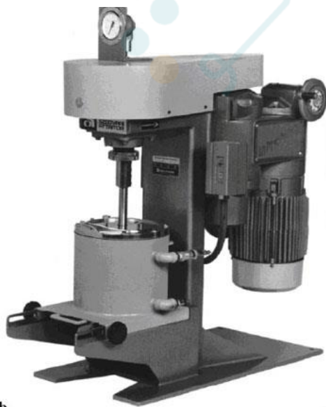
شکل ۴- آسیاب ساینده به همراه بخش‌های مختلف آن -a- شماتیک -b- نمونه واقعی.
