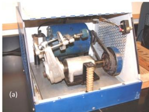
شکل ۳ -a- آسیاب نوع SPEX8000 و -b- محفظه کاربرد تنگستن به همراه گلوله و واشر جهت آب‌بندی آن.
