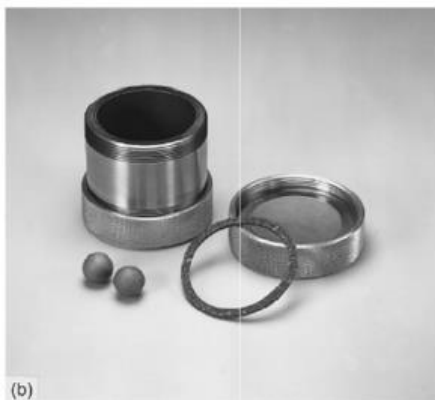
شکل ۳ -a- آسیاب نوع SPEX8000 و -b- محفظه کاربرد تنگستن به همراه گلوله و واشر جهت آب‌بندی آن.
