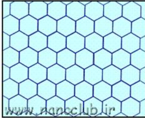
شکل ۱- طرحی ساده از ریزساختار ایده آل گرافیت
