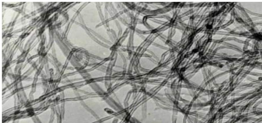
شکل ۷- تصویر میکروسکوپ الکترونی عبوری (TEM) از نانولوله های کربنی سنتز شده با روش رسوب دهی شیمیایی از فاز بخار [5].
