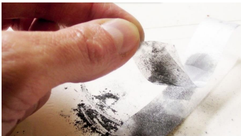
شکل ۱۰- روش لایه‌برداری مکانیکی برای سنتز گرافن از گرافیت با نظم بلوری بالا.
