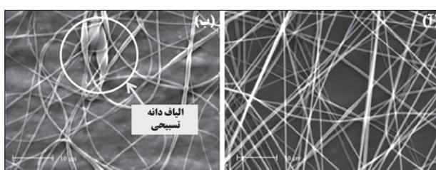
شکل ۸۰- نشکل الیاف دانه تسیبی در اثر افزایش دبی تزریق محلول بسپار، مربوط به الیاف از جنس پلی‌سولفون که از محلول با غلظت ۲۰٪ وزنی و حلال دی‌متیل‌استیل آمید و استون تهیه شده است. اختلاف پتانسیل اعمالی ۱۰ kV و دبی تزریق محلول برابر با (a) ۴۴ ml.h<sup>-۱</sup> و (b) ۶۶ ml.h<sup>-۱</sup> [۵۹].
