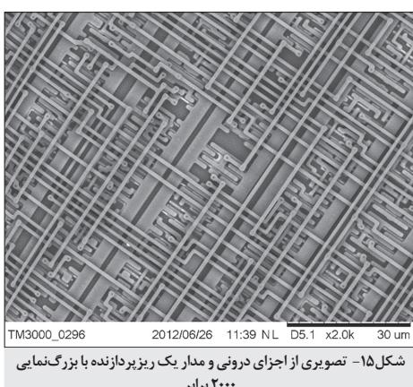
شکل ۱۵- تصویری از اجزای درونی و مدار یک ریزپردازنده با بزرگنمایی ۲۰۰۰ پار
