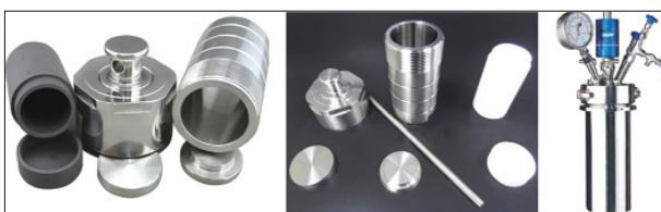
شکل ۲۲- ظروف داخلی و خارجی اتوکلاوهای آزمایشگاهی و نمونه‌ای از اتوکلاو دارای
