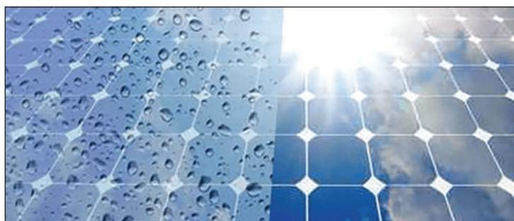
شکل ۱۶- تصویری از یک سلول خورشیدی که بخشی از سطح آن با استفاده از لایه‌ای بسیار نازک ابرآب‌گریز شده است
