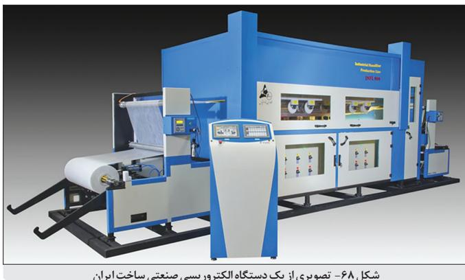
شکل ۶۸- تصویری از یک دستگاه الکترورسی صنعتی ساخت ایران
