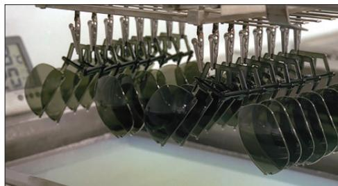
شکل ۱۷- فرایند پوشش دهنده شیشه‌های عینک توسط فرایند غوطه‌وری [۱۶۴]
