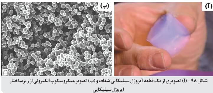
شکل ۹۸- (آ) تصویری از یک قطعه آیروژل سیلیکایی شفاف و (ب) تصویر میکروسکوپ الکترونی از ریزساختار آیروژل سیلیکایی
