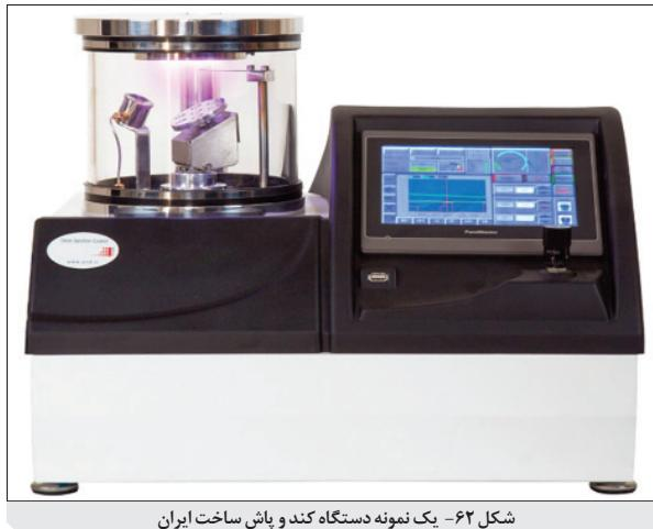
شکل ۶۲- یک نمونه دستگاه کند و پاش ساخت ایران
