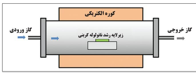
شکل ۴۱- طرح واره دستگاه رسوب بخار شیمیایی [۹۲]
