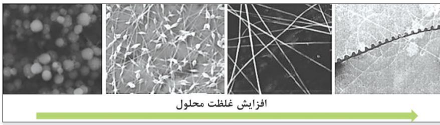
شکل ۷۵- روند تغییر شکل الیاف با افزایش غلظت محلول/مذاب بسپار [۵۹]
