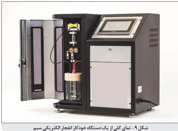
شکل ۹- نمای کلی از یک دستگاه خودکار انفجار الکتریکی سیم
