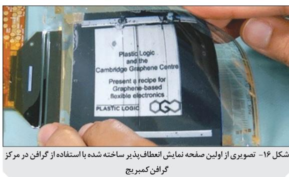
شکل ۱۶- تصویری از اولین صفحه نمایش انعطاف‌پذیر ساخته شده با استفاده از گرافن در مرکز گرافن کمپریج
