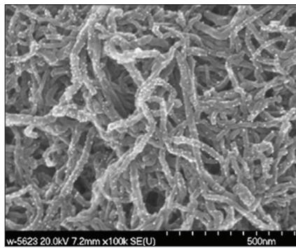
شکل ۲۹ - تصویر میکروسکوپ الکترونی روبشی از نانوذرات پلاتین ( نقطه‌های روشن ) روی نانولوله‌های کربنی چنددیواره استفاده شده به عنوان کاتالیست پیل سوختی [۱۷۲]
