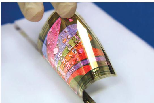
شکل ۱۴- یک صفحه نمایش انعطاف‌پذیر بسیار نازک که با فناوری لایه‌های نازک ساخته شده است [۱۶۳]
