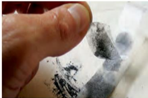
شکل ۱- ساخت یک لایه گرافن از گرافیت با چسب.
