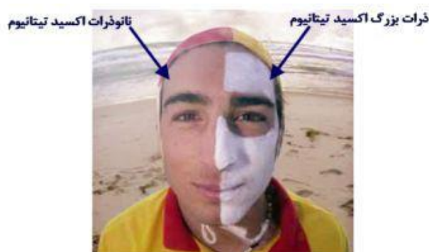
شکل ۴: تغییر رنگ ذرات اکسیدتیتانیوم بر حسب اندازه
