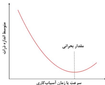
شکل ۵- منحنی تغییرات متوسط اندازه‌ی ذرات به‌عنوان تابعی از سرعت یا زمان آسیاب کاری.
