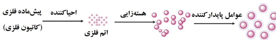
شکل ۱- شمایی از مراحل روش احیا شیمیایی
