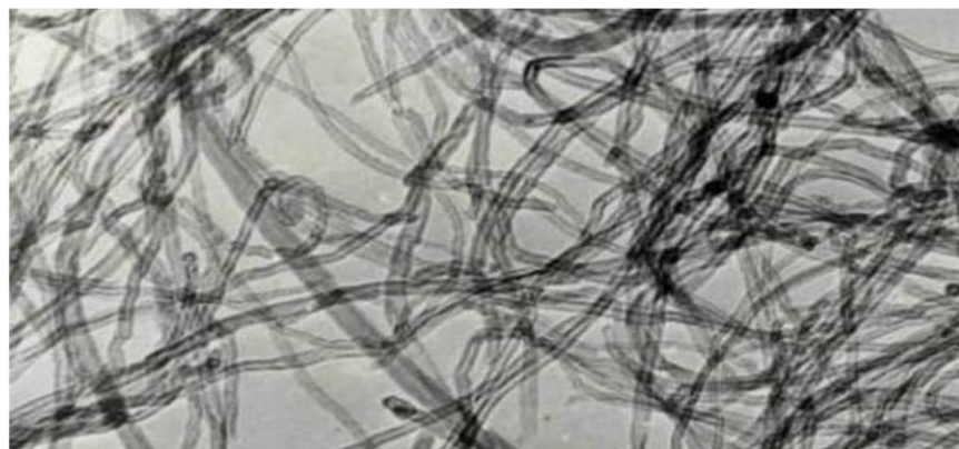
شکل ۷- تصویر میکروسکوپ الکترونی عبوری (TEM) از نانولوله‌های کربنی سنتز شده با روش رسوب‌دهی شیمیایی از فاز بخار [۵].
