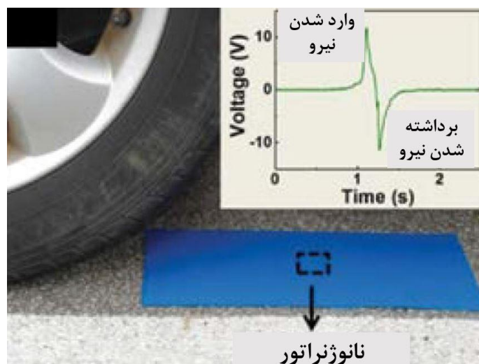
شکل ۸- استفاده از نانوسیم‌های اکسید روی به عنوان نانوژنراتور برای تولید الکتریسیته از حرکت خودروها بر روی صفحه نانوژنراتور
