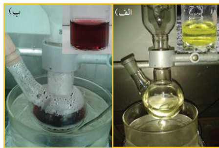
شکل ۱: (الف) محلول زرد رنگ هیدروژن تترا کلروآورات ( \text{HAuCl}_4 \cdot 3\text{H}_2\text{O} )، (ب) محلول قرمز نانوذرات طلا سنتز شده
