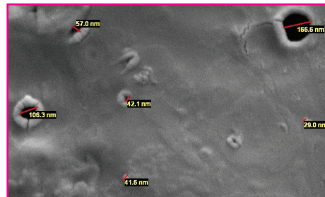
شکل ۱: تصویر نانوساختارهای متخلخل گرفته شده با میکروسکوپ الکترونی
