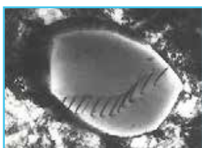
شکل ۵- جا به جایی در ساختار فولاد، خطا در شبکه بلوری
