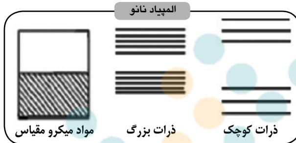
شکل ۹: ساختار الکترونی ذرات بر حسب اندازه آنها
