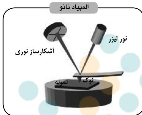
شکل ۱۱ : روش کار نانوسکوپ AFM
