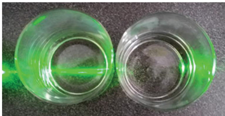
شکل ۱۰: نحوه پراکنش باریکه لیزر توسط نانوذرات نقره معلق در آب و مقایسه عبور این باریکه از آب خالص [۷].
