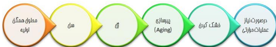
شکل ۵- مراحل مختلف سل ژل و جایگاه فرآیند Aging در آن
